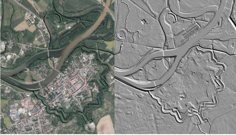
Mapa 3. Przykładowy model terenu przed i po zastosowaniu technologii LIDAR
