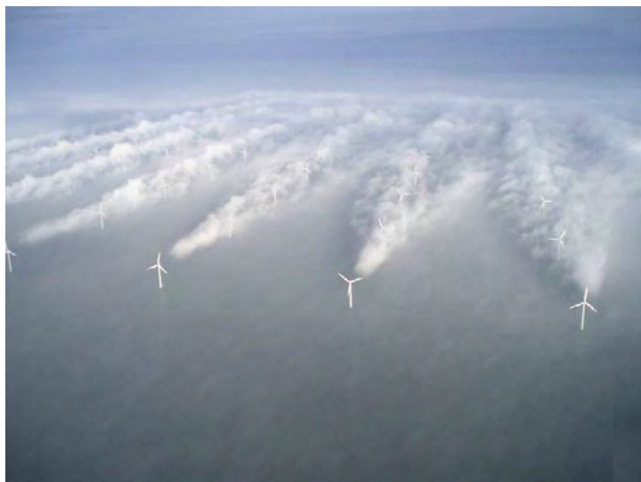
Rysunek 10. Ilustracja efektu wpływu sąsiednich turbozespołów na rozkład wiatru Źródło: twistedsiffer.com [dostęp: 29.01.2020].
